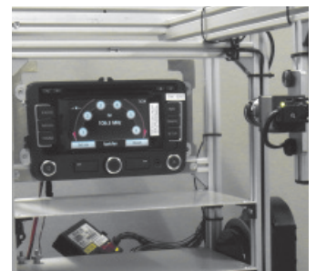
Sistema di ispezione ottica che fotografa ogni singolo elemento dello schermo del sistema di infotainment per il riconoscimento del testo e la verifica.
